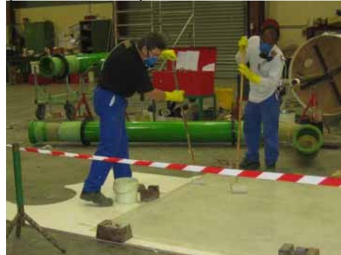
**Sous-vide:** Injection de la résine dans un moule sous vide enduit de renfort
