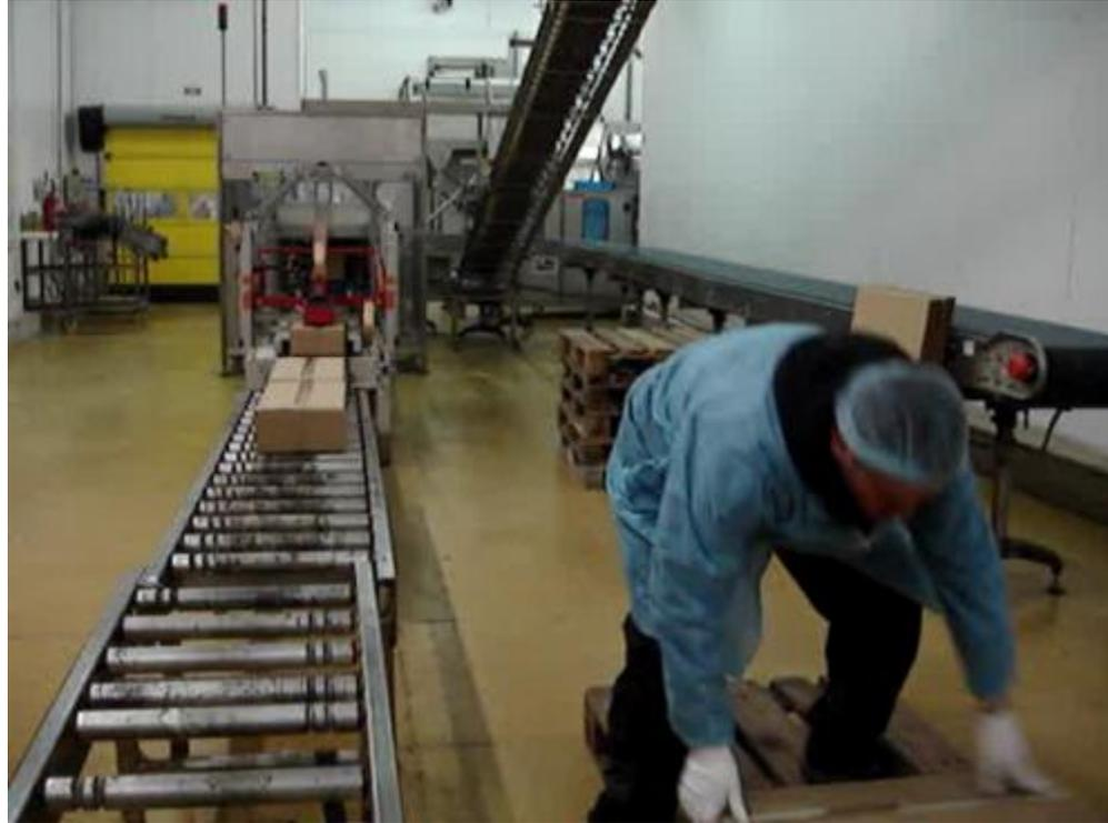
Mise de sacs de pains crus surgelés dans des chariots « Rolls » ou dans des « combi-box ».
